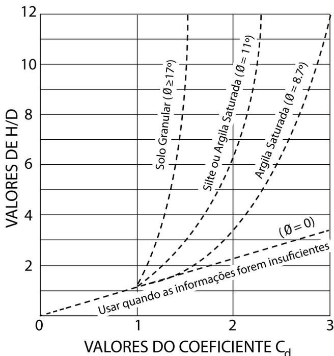
A fórmula geral para o cálculo de esforços atuantes, definida pela AASTHO, divide as solicitações entre a carga viva e carga morta. A carga viva é função do tipo e da profundidade do túnel; a carga morta é função do peso específico do solo, da altura de recobrimento e do coeficiente de redução da Fórmula de Marston, obtido através do gráfico ao lado:
